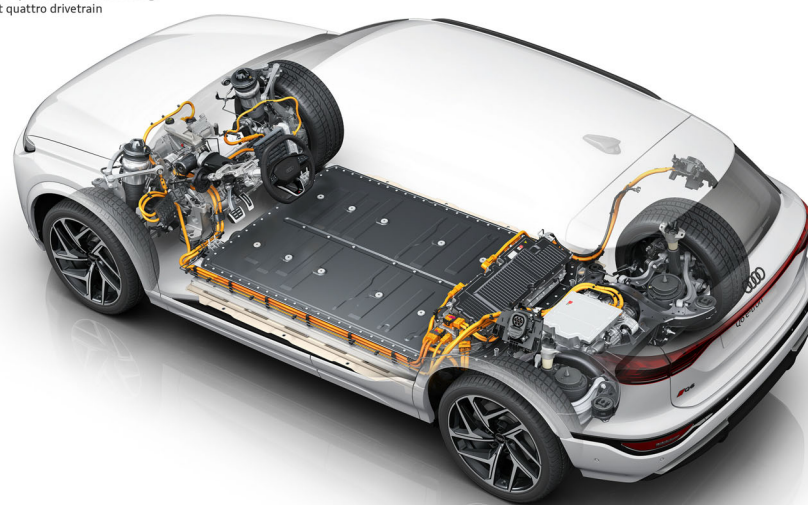
Audi Q6 e-tron quattro 800 Volt quattro Antriebsstrang 800 volt quattro drivetrain 03/24
